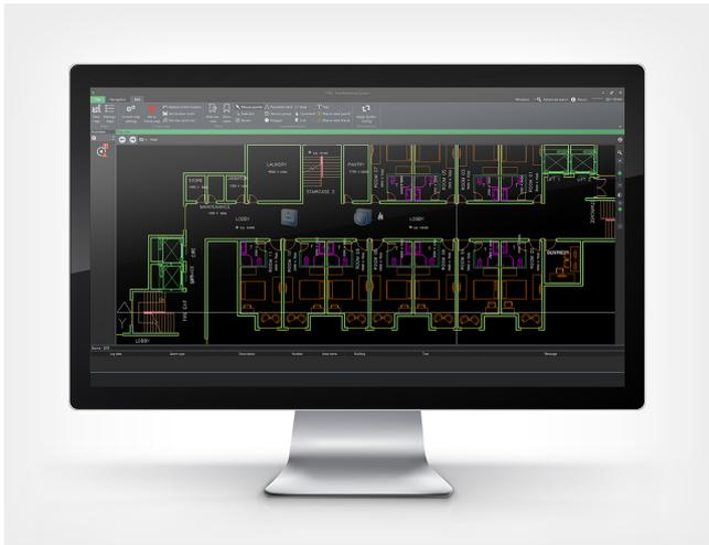
Системата за противопожарно наблюдение представлява графичен потребителски интерфейс за показване и наблюдение на малки до средни пожароизвестителни системи с до 10000 точки за откриване на пожар. Съвместима е с AVENAR panel 8000, AVENAR panel 2000, FPA-5000 и FPA-1200.
