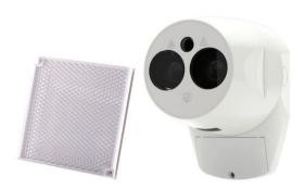
La unidad FRAY-ONE-UL es un detector de haz lineal retrorreflectante económico y de fácil montaje. Cubre distancia entre 5 m y 120 m (16 ft-393 ft). Un prisma reflectante permite detectar con precisión partículas de humo dentro de un rango de distancia determinado.
