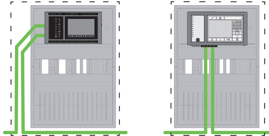
Şekil 7.2: CAN üzerinden panel ağı
