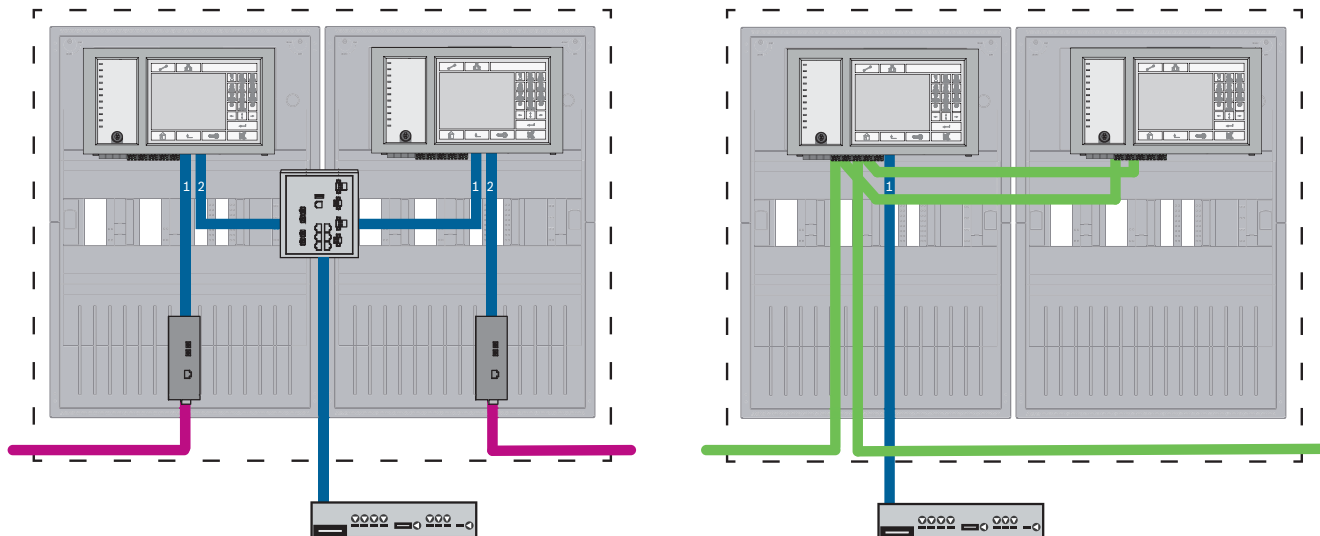
Afbeelding 7.9: Linkerzijde: in Ethernet-netwerk, rechterzijde: in CAN-netwerk
