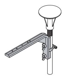
Suporte de Montagem para montar o detector em cavidades no chão.
