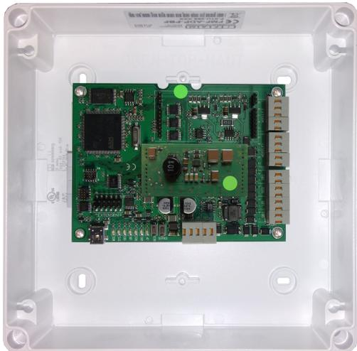
Das Ringbusmodul FMF-ADP-TTY dient zur Anschaltung von Feuerwehr-Peripheriegeräten (FBF und FAT) an die Brandmelderzentralen FPA-5000/1200/1100.
