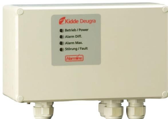
Le détecteur de chaleur linéaire FCS-LWM-1 est destiné à la détection d'incendie. Son fonctionnement s'appuie sur la modification de la résistance d'un conducteur électrique, causée par une augmentation de la température.
