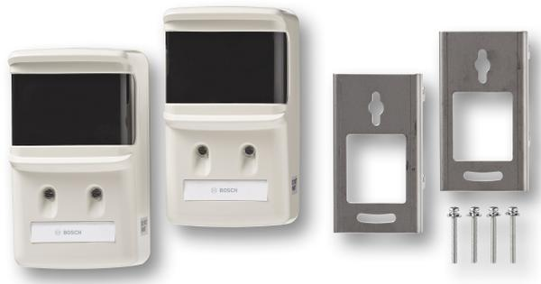
Ce détecteur de fumée à faisceau projeté se compose d'un émetteur et d'un récepteur. Ce détecteur doit être positionné de sorte que la fumée générée par un incendie s'élève et traverse le trajet du faisceau. Le récepteur surveille et mesure en continu l'intensité du faisceau transmis par l'émetteur. Si la fumée provenant d'un incendie entraîne une diminution de l'intensité du signal d'une magnitude qui dépasse la valeur d'obscurcissement programmée, un signal d'alarme est généré.
