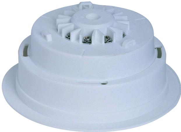
FCA-500-EU Sockel sind zur Montage der FCP-500 Melder erforderlich. Der FCA-500-E-EU wird an letzter Position einer Stickleitung eingesetzt und mit einem EOL-Widerstand versehen.
