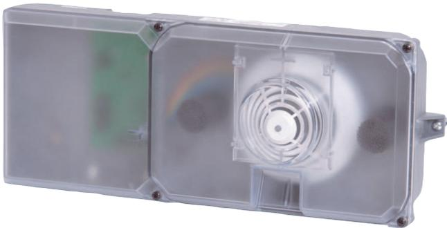
Das FAD-420-HS-EN Lüftungskanal-Meldergehäuse mit Sockel (für die Aufnahme eines FAD-425-O-R Melders) detektiert Rauch in Lüftungskanälen. In der Luft befindliche Rauchpartikel werden zuverlässig erkannt und über das optimierte LSN improved Bussystem an die Brandmelderzentrale gemeldet.
