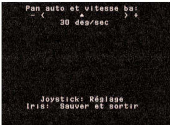
Figure 6 Réglage des vitesses pan. auto / bal. auto
