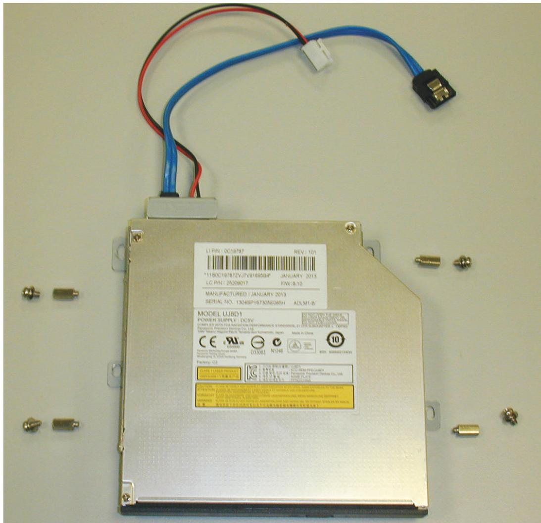
Figura 5.9: Componentes de instalação do DVD no DIVAR AN 5000
