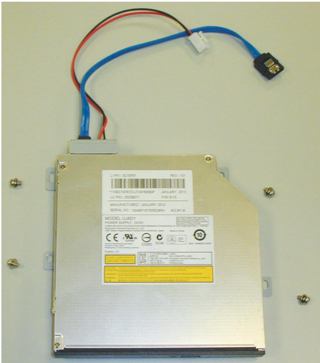
Figura 5.7: Componentes de instalação do DVD para o DIVAR AN 3000
