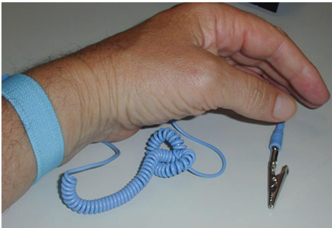
**Figura 5.3: Pulseira contra descargas eletrostáticas**
