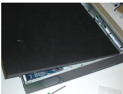
Rysunek 5.10: Instalacja nagrywarki DVD w urządzeniu DIVAR AN 5000
