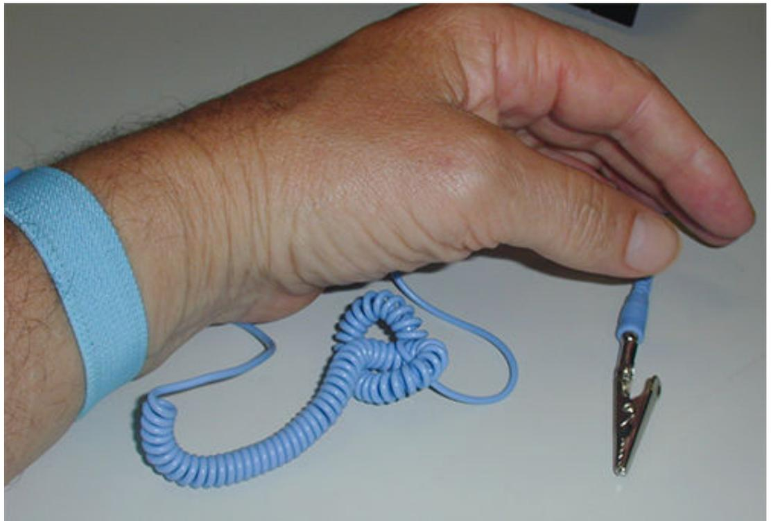
**Figure 5.3: Bracelet de décharge électrostatique**
