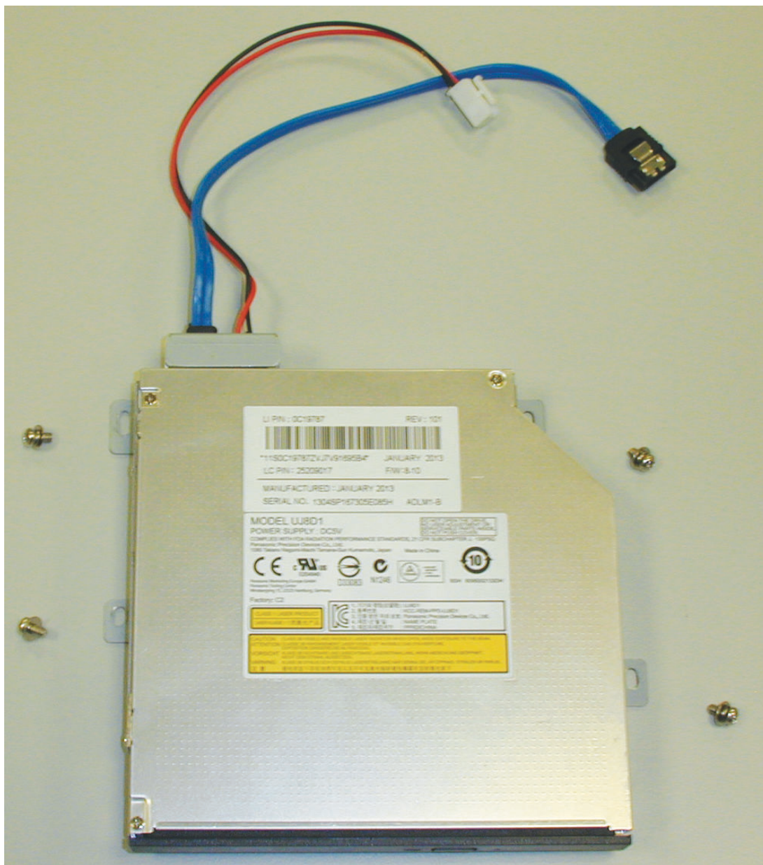
Bild 5.7: Installationskomponenten eines DVD-Laufwerks für DIVAR AN 3000
