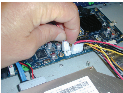
Bild 5.8: Installation eines DVD-Laufwerks im DIVAR AN 3000
