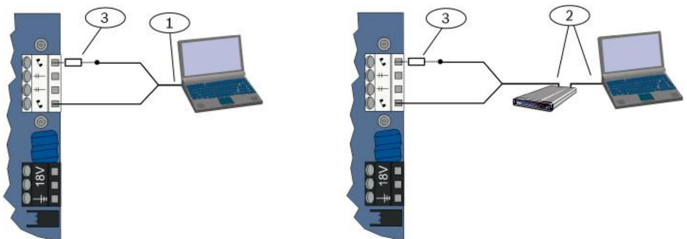
Imagen 4.1: Conexiones por módem
