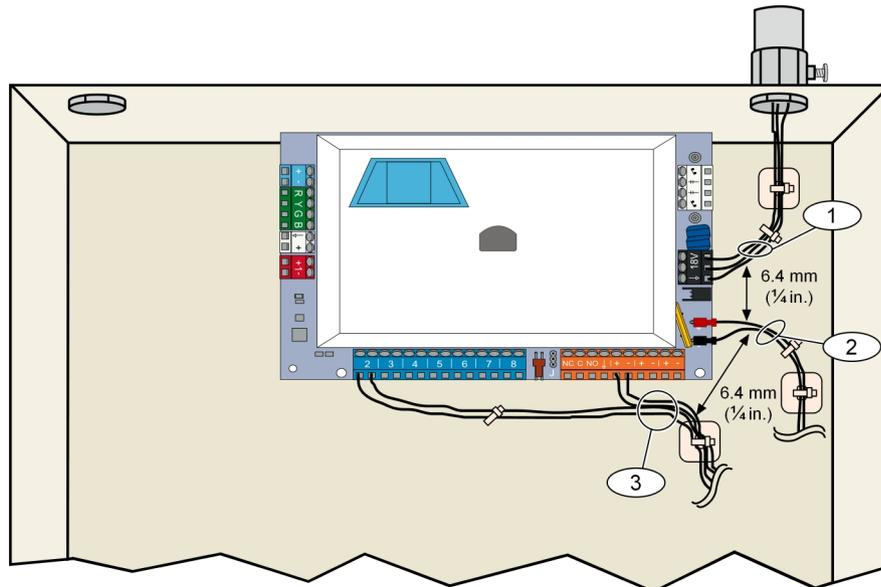
Imagen 3.2: Enrutamiento del cableado de potencia limitada
