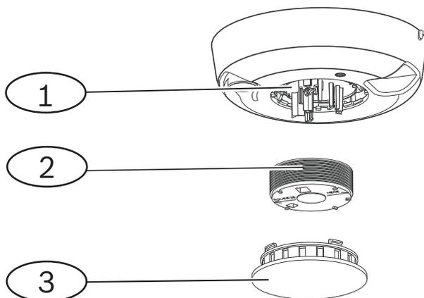
**Imagen 8.7:** Extracción de la tapa del detector
