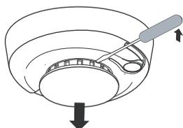
**Imagen 8.6:** Extracción de la tapa del detector
