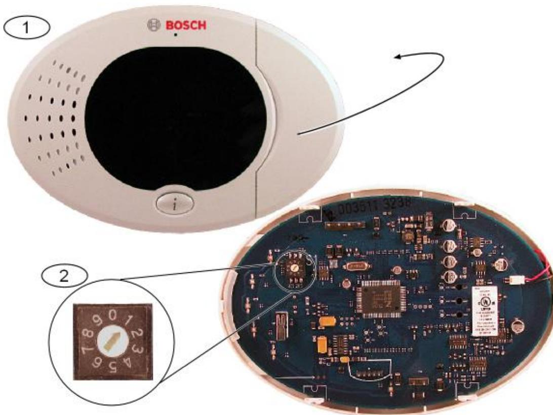
Imagen 3.1: Interruptor de direcciones del centro de control
