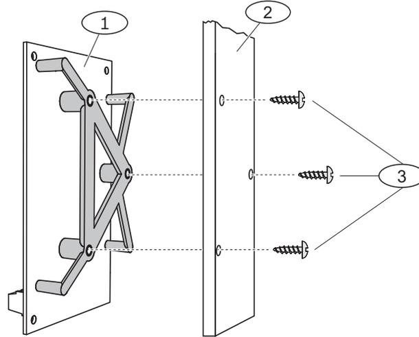
Imagen 3.3: Montaje del módulo
