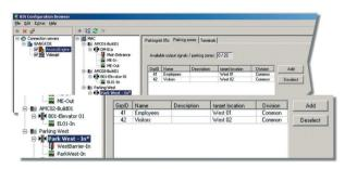
此功能可定義及使用「停車場」門禁模式,此模式內含對入口與出口的兩道障礙及其交通燈號的控制,當停車場達到最大容量時可以停止進入。
