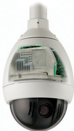
Модульная система камер AutoDome компании Bosch представляет собой революционное решение в области купольных камер. Вся система AutoDome основана на пяти типах сменных модулей: центральный процессор, камера, кожух, модуль связи и источник питания.
