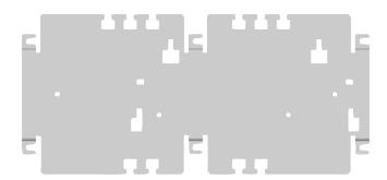
Монтажное основание HMP 0003 A используется в обеих больших монтажных рамах FBH 0000 A и FHS 0000 A.
