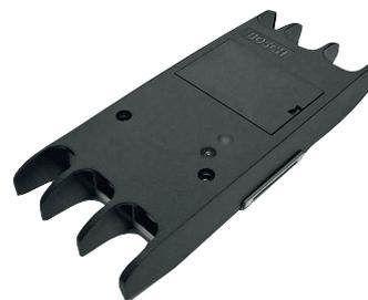
O repartidor de rede permite que a linha principal de rede seja dividida em várias ramificações. As linhas em derivação são monitorizadas, mas não apresentam a cablagem redundante da linha de rede principal. O repartidor de rede possui uma opção de ligar uma alimentação de 48 Vdc que permite fornecer potência adicional, se necessário. O repartidor de rede também pode ser utilizado como um repetidor para aumentar o comprimento do cabo de fibra de plástico com mais 50 metros.
