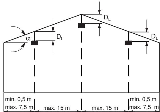
**Nota** A distância ao tecto, no caso dos telhados de duas águas, pode ser reduzida em 1 % por cada grau, até um máximo de 25 %.
