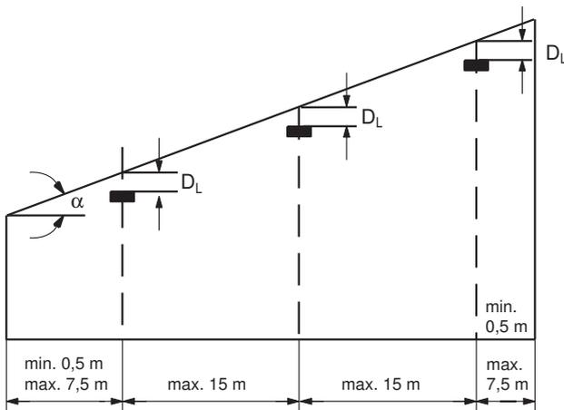
**Posicionamento dos detectores sob um telhado de duas águas**
