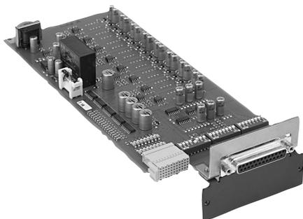
Il modulo LBB 3422/20 per ingresso audio simmetrico e postazioni interpreti viene utilizzato per interfacciare il trasmettitore con i sistemi per dibattiti CCS 900 e la postazione per interprete a 6 canali con altoparlante LBB 3222/04. Sono possibili diverse connessioni ed impostazioni dello switch per consentire l'utilizzo del modulo anche con sistemi non Bosch.
