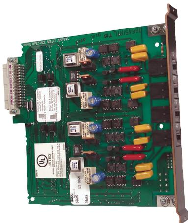
Tableau enfichable modulaire. Assure isolement et suppression des transitoires pour la carte de ligne téléphonique Conettix D6641. Offre quatre connecteurs modulaires RJ11 pour la connexion de lignes téléphoniques.
