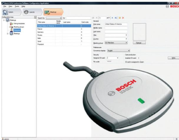
Das Chipkarten-Codierungsmodul dient zur Codierung von Chipkarten. Chipkarten werden zur Identifizierung von Delegierten während einer Konferenz verwendet. Der Chipkartenkodierer (USB) (DCN-IDENC) und das DCN-SW Conference Software Hauptmodul werden für die Erstellung von Chipkarten benötigt.
