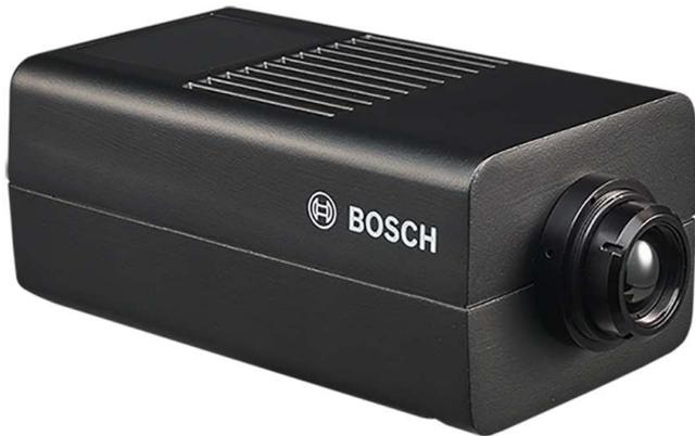
DINION IP thermal 9000 RM摄像机采用非致冷钒氧化物微测辐射热计，无需接触目标，即可在短距离内测量其表面温度。摄像机配备QVGA传感器，帧速率可达9 FPS。
