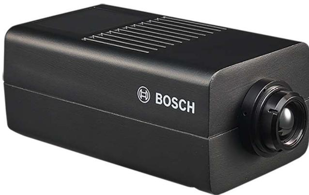
Mit der DINION IP thermal 9000 RM Kamera, die auf einem ungekühlten Mikrobolometer (Vanadiumoxid) basiert, lässt sich eine Oberflächentemperatur auf kurze Distanz berührungslos messen. Die Kamera verfügt über einen QVGA-Sensor mit einer Bildfrequenz von 9 Bilder/s.
