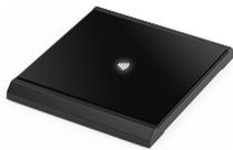
DCNM-FIDPは、NFCタグ識別による迅速な参加者識別をサポートします。識別により、会議参加者の出席登録と認証が可能になります。識別後には参加者の認証情報とヘッドホン音声言語が設定され、セキュリティと使いやすさの確保に役立ちます。意図しない識別動作の発生を防ぐため、この装置によるIDカード検出距離は0~1 cmです。
