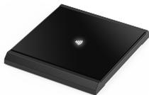
Il DCNM-FIDP supporta il riconoscimento rapido dei partecipanti tramite l'identificazione di tag NFC. L'identificazione consente la registrazione delle presenze e l'autorizzazione del partecipante ad accedere alla riunione. Dopo l'identificazione, le autorizzazioni e la lingua delle cuffie vengono impostate per garantire la sicurezza e la facilità d'uso.
