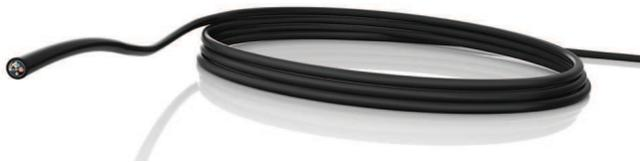
此系統安裝纜線是用於建立自訂長度的系統安裝纜線。系統安裝纜線可以透過使用系統纜線工具箱 (DCNM-CBCON) 與實芯纜線的連接器 (DCNM-CBTK) 端接，製作最大長度為 100 公尺 (328 英尺) 的纜線。纜線為實芯，可為 5 公尺以上的纜線提供更好的效能。此纜線不適用於經常連接和中斷連接纜線的應用情境。請對這類應用情境使用 DCNM-CBxx-I 纜線。
