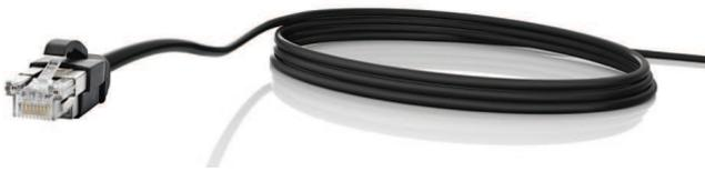
DICENTIS系统电缆组件两端带与RJ45相似的接头, 具有额外的电源引脚。电缆组件用于将DICENTIS设备连接到音频供电交换机或供电交换机。它通过同一根电缆实现网络通信和电源传输。需要环路和冗余电缆连接时, 会使用电缆组件。电缆组件采用低烟零卤素外壳, 符合安全和环境标准。这些电缆采用实心设计, 在电缆长度超过5米时性能更佳。
