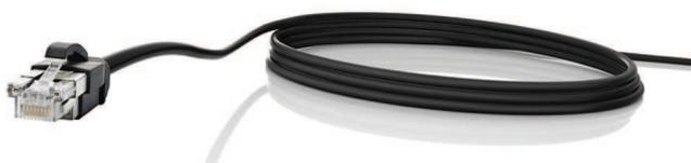
DICENTIS システム ケーブル アセンブリの両端には、追加の電源ピンがついたような RJ45 コネクタが付いています。ケーブル アセンブリは、DICENTIS デバイスをオーディオ電源スイッチング ハブ、または電源スイッチング ハブに接続するのに使用されます。1 本のケーブルでネットワーク通信と電源の供給が行えます。ケーブル アセンブリは、ループスルーと冗長ケーブル接続が必要とされる時に使用されます。また、ケーブル アセンブリは低発煙でハロゲン無しの被覆材でできており、安全基準および環境基準に準拠しています。ケーブルはソリッドコアです。これは、長さが 5 メートル以上のケーブルのパフォーマンスを高めます。
