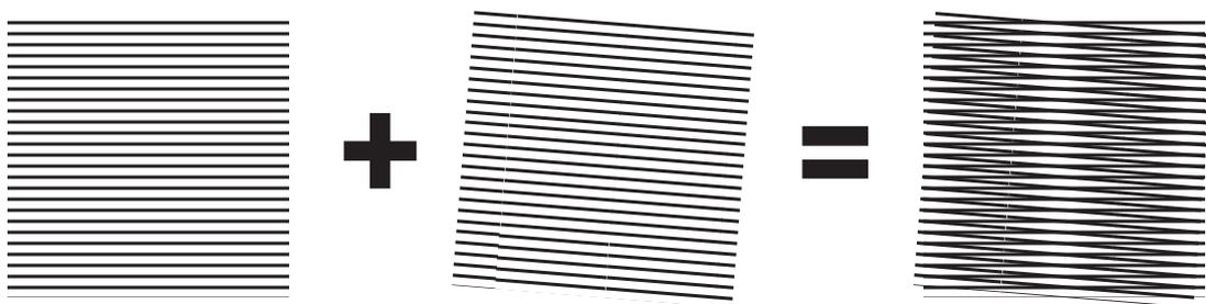
Figure 4.1: Effet Moiré causé par deux motifs superposés (exemple)
