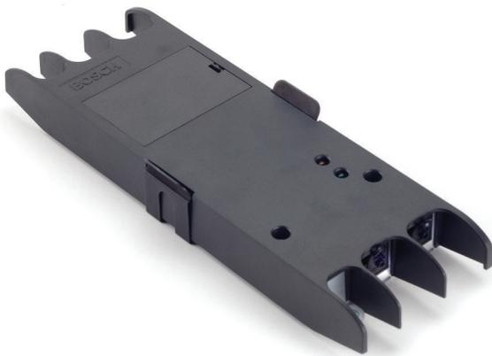
Las unidades de los interruptores controladores de red redundante (RCS) PSP-D00039 maestra y PSP-D00040 esclava son unas versiones especiales del divisor de red PRS-NSP; son mecánica y electrónicamente idénticas al divisor de red, pero cuentan con un firmware diferente para establecer un cambio automático desde un controlador de red principal a un controlador de red de reserva.
