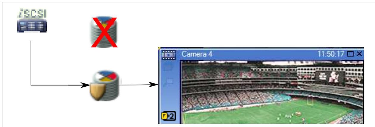
Quando il VRM secondario e il VRM di failover secondario opzionale sono entrambi non collegati, l'encoder fornisce la riproduzione. Chiudere il riquadro Immagine e trascinare nuovamente la telecamera in un riquadro Immagine:
