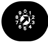
Afbeelding 4.3: Adresschakelaar is ingesteld op adres 1
