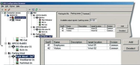
此功能可定義及使用「停車場」門禁模式，此模式內含對入口與出口的兩道障礙及其交通燈號的控制，當停車場達到最大容量時可以停止進入。
