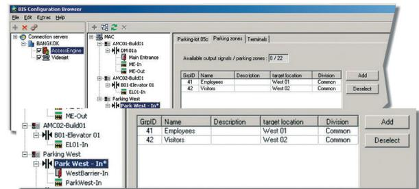
Este recurso permite definir e utilizar o modelo de porta para “estacionamento”. Este modelo contém o controle de duas barreiras de entrada e saída e as luzes de tráfego, as quais impedem o acesso quando o estacionamento atinge a capacidade máxima.
