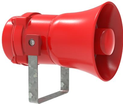
Diese leistungsstarke, Ex-geschützte Sirene ist nach EN60079-0:2006 und EN60079-1:2007 für die akustische Signalisierung in Brandmeldesystemen zertifiziert und entspricht der EN 54-3. Die Sirene erfüllt die Anforderungen der ATEX-Richtlinie 94/9/EG und kann in explosionsgefährdeten Bereichen eingesetzt werden, in denen potenziell entflammbare Atmosphären vorhanden sein können.
