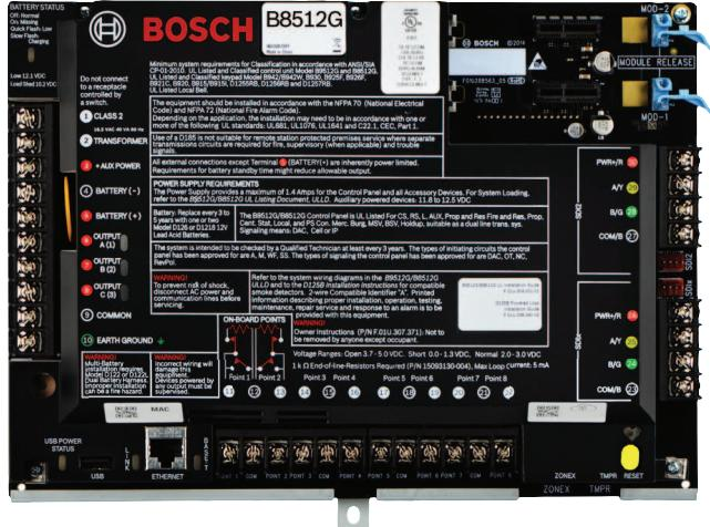
O B8512G Painel de Controle e o B8512G Painel de Controle são os novos painéis de controle comerciais de primeira linha da Bosch. Os B8512G painéis de controle integram controles de intrusão, incêndio e acesso, fornecendo uma interface de usuário simples para todos os sistemas.
