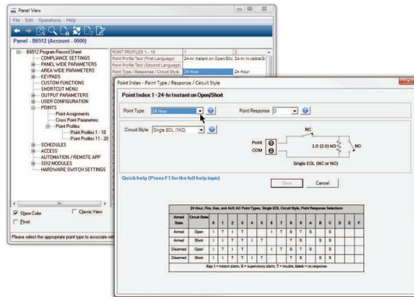
Os parâmetros de Resposta de ponto e Tipo de ponto determinam conjuntamente como o painel de controle responde a mudanças nos loops de sensor de ponto (aberto, em curto, normal) para pontos com fio, ou mudanças em estados de ponto para dispositivos de ponto sem fio (falha, normal, problema).
