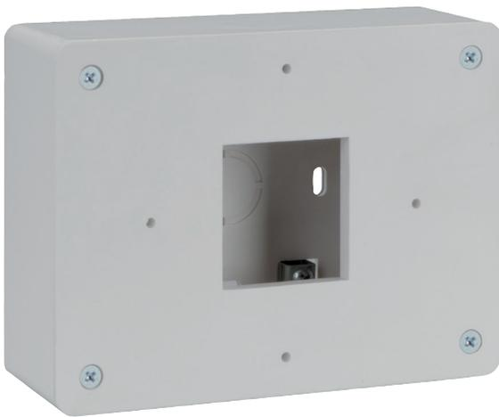
Adecuado para las instalaciones que usen conductos para proteger los cables del teclado. El teclado se monta en la cubierta frontal de la caja. La caja incluye un nivel de burbuja de aire integrado para facilitar la instalación. Las dimensiones son 5,5 in x 4,1 in x 1,7 in (140 mm x 105 mm x 44 mm) y los materiales son plástico ABS (Acrilonitrilo Butadieno Estireno) y acero electrogalvanizado CRS G40.
