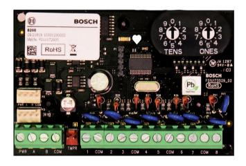
B208 8路输入模块是一个八防区扩展设备,可通过SDI2总 线连接到报警主机。此模块受到全面监测并将所有防区状态 更改传回至报警主机。模块扩展防区的操作与报警主机上的 防区操作相同。
