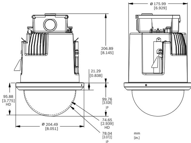
Dimensões da AUTODOME 7000 - montagem encastrada no tecto
