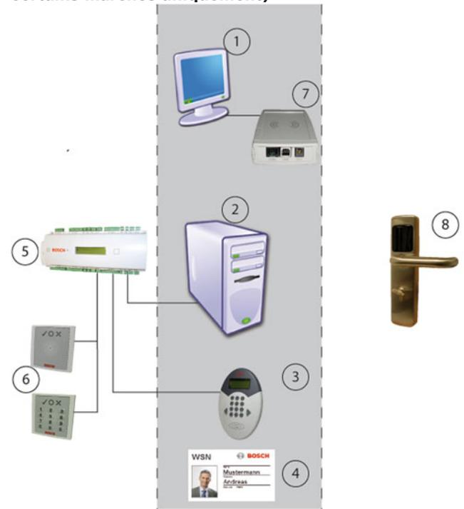
Le système de verrouillage hors ligne utilise certains composants du système en ligne. Dans l'illustration ci-dessus, l'encadré sur fond gris indique les périphériques qui sont utilisés sur les deux systèmes. Les périphériques du système en ligne apparaissent à gauche tandis que ceux du système de verrouillage hors ligne apparaissent à droite.
