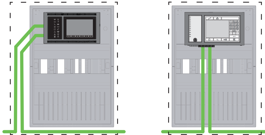
Afbeelding 7.2: Centraalnetwerk via CAN
