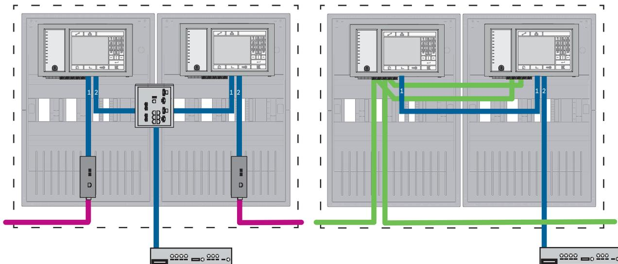
Abbildung 7.10: Links: im Ethernet-Netzwerk Rechts: im CAN-Netzwerk
