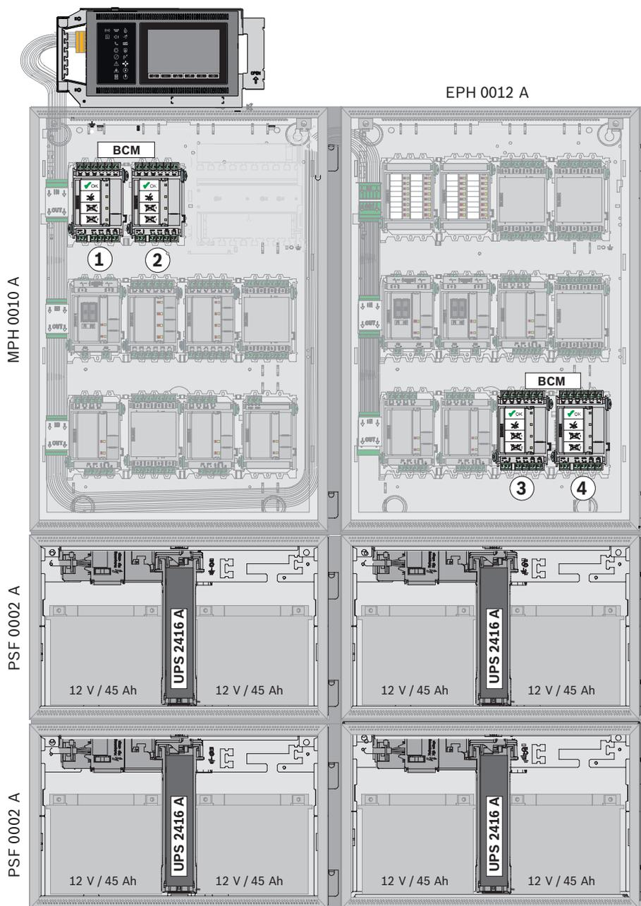
Рис. 3.6: Сборка из 1–4 модулей BCM (установка в раму)
