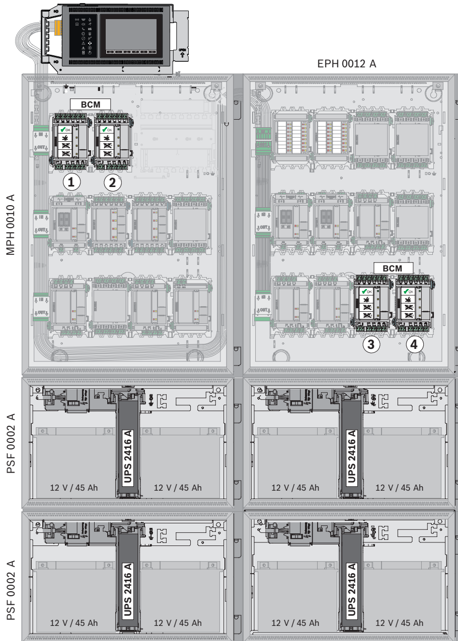
Abbildung 3.6: Montage von 1 bis 4 BCM-Modulen (Rahmenmontage)
