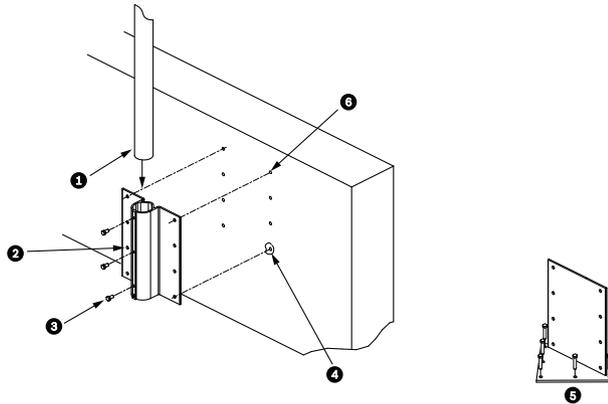
图片 7.1: 护栏墙壁底座支架和屋顶底座板
