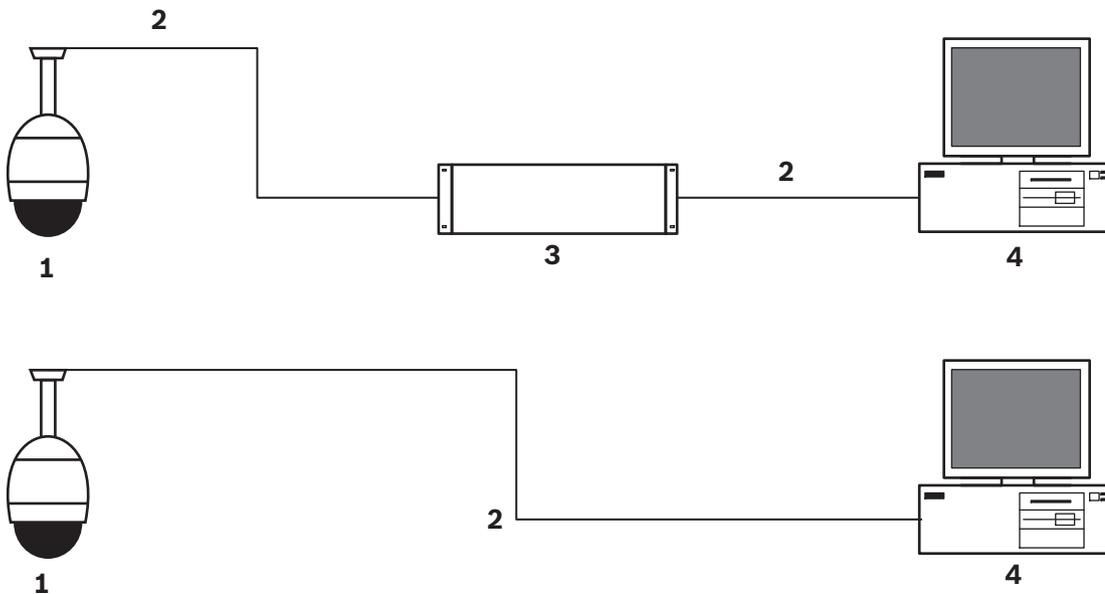
图片 8.1: AUTODOME IP 系统配置
