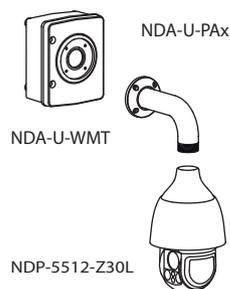
Fig. 1: Montage mural avec boîtier de surveillance (IP66)
